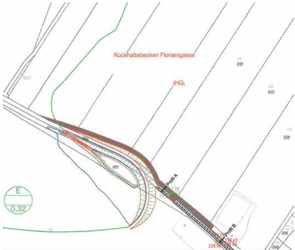
Das Rückhaltvolumen des Dammbauwerks beträgt 8.600 m<sup>3</sup>, das Beckenvolumen beträgt 690 m<sup>3</sup>.
